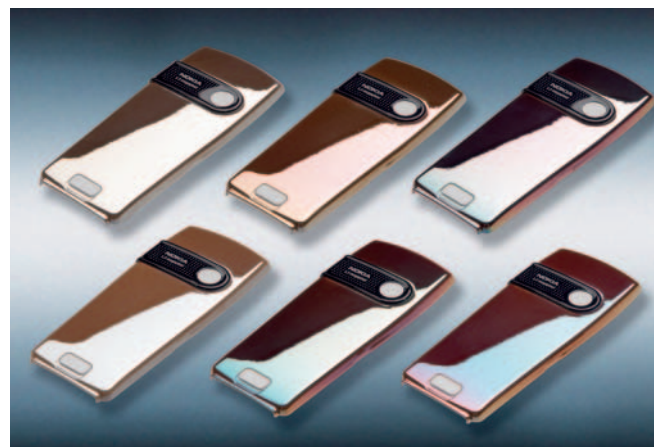
Chromoberfläche auf Handyschalen, die durch PVD sowie das vor- bzw. nachgeschaltete Lackieren der Spritzteile hergestellt wurde. Dreidimensionale Oberflächen lassen sich auf diese Weise problemlos durch den Auftrag unterschiedlicher Metalle veredeln
