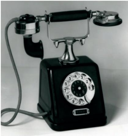
**Bild 6.** Der Tischapparat „SA 19 (07) F“ von 1919 enthält neben lackiertem Blech und Komponenten aus Nickelguss bereits Teile aus Ebonit, einem Vorläufer des Bakelit (Foto: Siemens
