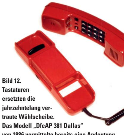
**Bild 12.** Tastaturen ersetzen die jahrzehntelang vertraute Wählscheibe. Das Modell „DfeAP 381 Dallas“ von 1986 vermittelte bereits eine Andeutung von Mobilität (Fotos: Siemens Corporate Archives)
