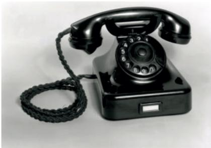
**Bild 8.** Der Telefonklassiker W36/38 war vollständig aus Bakelit gefertigt; rechts ein Sondermodell in vergoldeter Ausführung für das griechische Königshaus (Fotos: Siemens Corporate Archives)
