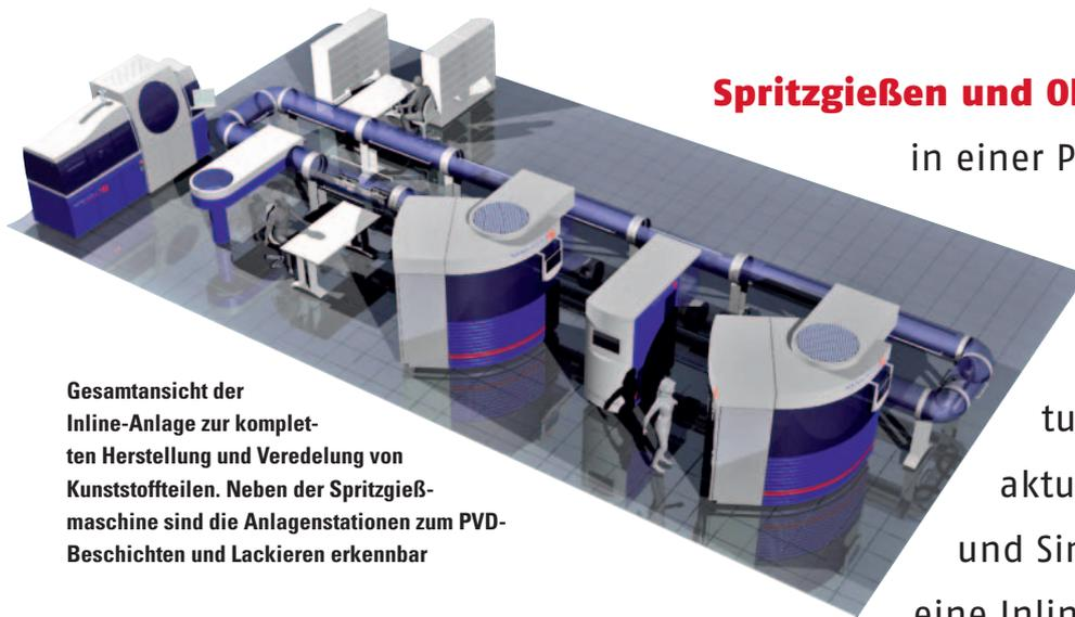
Gesamtansicht der Inline-Anlage zur kompletten Herstellung und Veredelung von Kunststoffteilen. Neben der Spritzgießmaschine sind die Anlagenstationen zum PVD-Beschichten und Lackieren erkennbar
